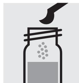
1 gestrichenen grünen Mikrolöffel  $\text{SO}_4\text{-1K}$  zugeben, mit Schraubkappe verschließen.
