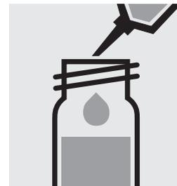
5,0 ml **OA-5** mit Pipette zugeben, mit Schraubkappe verschließen und kräftig schütteln.
