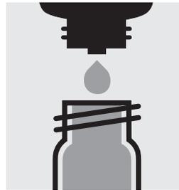
10 Tropfen O<sub>2</sub>-3K zugeben, Küvette verschließen, mischen und von außen säubern.
