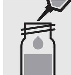
2,0 ml Probe mit Pipette zugeben, mit Schraubkappe verschließen und mischen.
