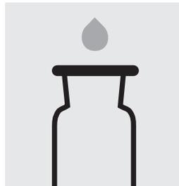
2 Sauerstoff-Reaktionsflaschen mit **vorbereiteter Probe** und 2 Glasperlen bis zum Überlauf füllen. Mit angeschrägtem Glasstopfen luftblasenfrei verschließen.
