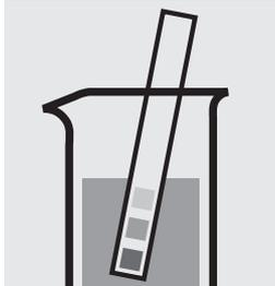
pH-Wert der Probe überprüfen, Soll-Bereich: pH 5–8. Falls erforderlich, tropfenweise mit verdünnter Natronlauge bzw. Salzsäure pH-Wert korrigieren.
