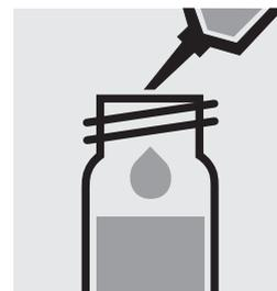
0,50 ml **Ca-2K** mit Pipette zugeben, mit Schraubkappe verschließen und mischen.
