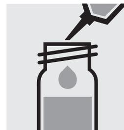
2,0 ml **Probe-Reagenz-Mischung** mit Pipette zugeben, mit Schraubkappe verschließen und mischen.
