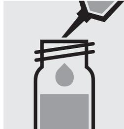
3,0 ml **abgereicherte Probe vorsichtig** in eine Reaktionsküvette pipettieren, mit Schraubkappe fest verschließen und kräftig mischen.
