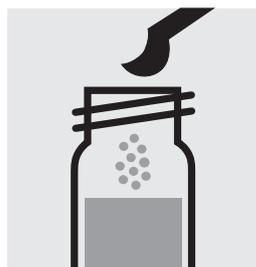
1 gestrichenen gelben Mikrolöffel **N-3K** in eine Reaktionsküvette geben, mit Schraubkappe verschließen.
