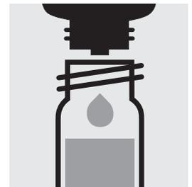
5 Tropfen **AOX-4** zugeben, mit Schraubkappe verschließen und mischen. Kohle absitzen lassen; überstehende Lösung: **vorbereitete Probe**.
