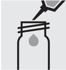
5,0 ml der Probe in eine leere Rundküvette (Leerküvetten, Art. 114724) pipettieren.
