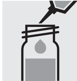
0,50 ml Probe in eine Reaktionsküvette pipetieren, mit Schraubkappe verschließen und mischen.
