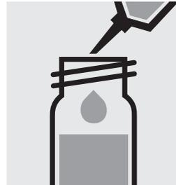
1,0 ml **H-1K** mit Pipette zugeben, mit Schraubkappe verschließen und mischen.
