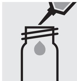
5,0 ml Probe in eine Reaktionsküvette pipetieren, mit Schraubkappe verschließen.
