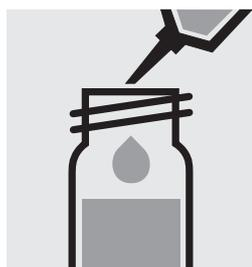
1,0 ml N-3K mit Pipette zugeben, mit Schraubkappe verschließen und mischen. **Vorsicht, Küvette wird heiß!**
