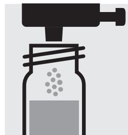
1 Dosis **P-1K** mit grünem Dosierer zugeben, mit Schraubkappe verschließen.
