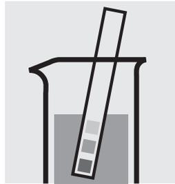
pH-Wert der Probe überprüfen, Soll-Bereich: pH 3 – 12. Falls erforderlich, tropfenweise mit verdünnter Natronlauge bzw. Schwefelsäure pH-Wert korrigieren.
