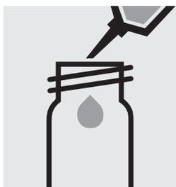
1,0 ml Probe in eine leere Rundkuvette (Leerküvetten, Art. 250621) pipettieren.
