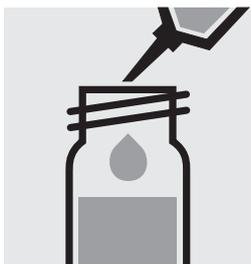
0,20 ml **AOX-1K** in eine Reaktionsküvette pipettieren und mischen.
