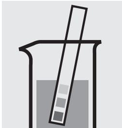
pH-Wert der Probe überprüfen, Soll-Bereich: pH 1–9. Falls erforderlich, tropfenweise mit verdünnter Natronlauge bzw. Schwefelsäure pH-Wert korrigieren.
