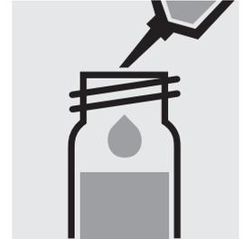
0,25 ml **Al-2K** mit Pipette zugeben, mit Schraubkappe verschließen und mischen.
