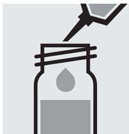
7,0 ml **vorbereitete Probe** mittels Glaspipette aus der Aufschlussküvette entnehmen (ohne Kohle) und in die Reaktionsküvette pipettieren, mit Schraubkappe verschließen und mischen.
