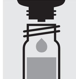
5 Tropfen **PO<sub>4</sub>-1K** zugeben, mit Schraubkappe verschließen und mischen.
