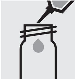
10 ml Probe in eine Rundküvette pipettieren.
