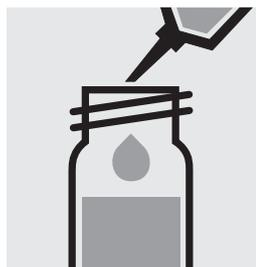
1,0 ml N-3K mit Pipette zugeben, mit Schraubkappe verschließen und mischen. **Vorsicht, Kuvette wird heiß!**
