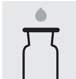
2 Sauerstoff-Reaktionsflaschen mit **angepflichter Nährsalzlösung** und 2 Glasperlen bis zum Überlauf füllen. Mit angeschrägtem Glasstopfen luftblasenfrei verschließen.
