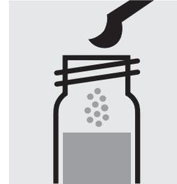
1 gestrichelten grünen Mikrolöffel SO<sub>4</sub>-1K zugeben, mit Schraubkappe verschließen.
