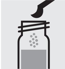
1 gestrichenen gelben Mikrolöffel **NO<sub>3</sub>-1K** in eine Reaktionsküvette geben, mit Schraubkappe verschließen.
