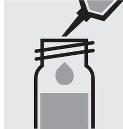
0,10 ml Probe mit Pipette zugeben, mit Schraubkappe verschließen und mischen. **Vorsicht, Küvette wird heiß!**
