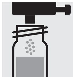
1 Dosis NH<sub>4</sub>-1K mit blauem Dosierer zugeben, mit Schraubkappe verschließen.
