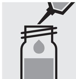
1,0 ml **vorbereitete Probe** in eine Reaktionskuvette pipettieren, **nicht mischen.**
