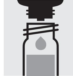
2 Tropfen **Ni-1K** zugeben, mit Schraubkappe verschließen und mischen.
