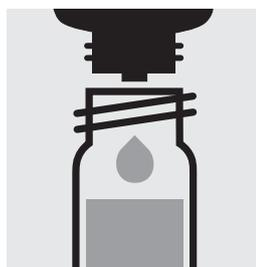
6 Tropfen N-2K zugeben, mit Schraubkappe verschließen und mischen.
