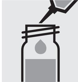
5,0 ml Probe in eine Reaktionsküvette pipetieren, mit Schraubkappe verschließen und mischen.
