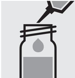
3,0 ml gerührte Probe in eine Reaktionsküvette pipettieren.
