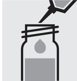
7,0 ml Probe in eine Reaktionsküvette pipetieren, mit Schraubkappe verschließen und mischen.
