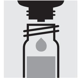
6 Tropfen **K-1K** zugeben, mit Schraubkappe verschließen und mischen.
