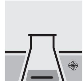
Beide Erlenmeyerkolben im Eisbad auf Raumtemperatur abkühlen lassen.
