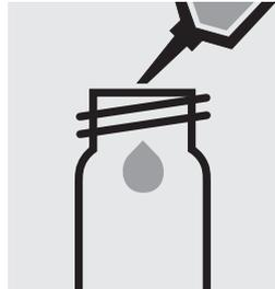
10 ml Probe in eine leere Rundkuvette (Leerküvetten, Art. 114724) pipettieren.
