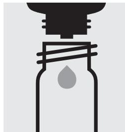
6 Tropfen **Cr-3K** in eine Reaktionskuvette geben, mit Schraubkappe verschließen.
