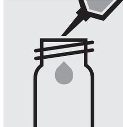
5,0 ml Probe in eine Reaktionsküvette pipetieren, mit Schraubkappe verschließen und Feststoff lösen.
