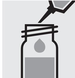
5,0 ml **abgereicherte Blindprobe vorsichtig** in eine zweite Reaktionsküvette pipettieren, mit Schraubkappe fest verschließen und kräftig mischen.
