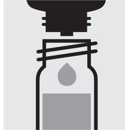
3 Tropfen **CN-2K** zugeben, mit Schraubkappe verschließen und mischen: **vorbereitete Probe**.
