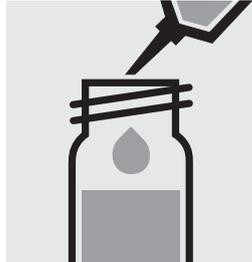
4,0 ml Probe in eine Reaktionsküvette pipetieren, mit Schraubkappe verschließen und mischen.
