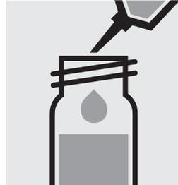
0,20 ml **RH-1K** mit Pipette zugeben, mit Schraubkappe verschließen und mischen.
