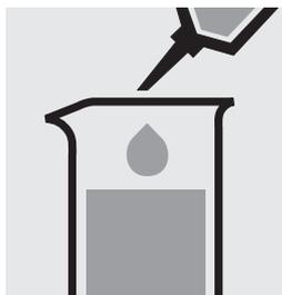
10 ml Probe in ein Glasgefäß pipettieren.
