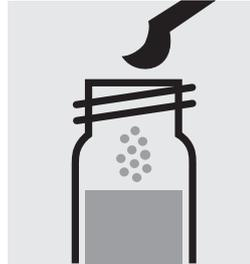
1 gestrichen blauen Mikrolöffel Cl<sub>2</sub>-1 zugeben, mit Schraubkappe verschließen.
