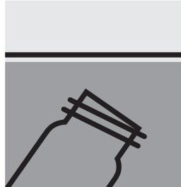
Reaktionsküvette luftblasenfrei (!) vollständig mit Wasserprobe füllen.
