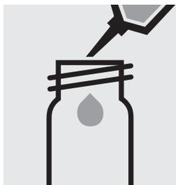
10 ml Probe in eine leere Rundküvette (Leerküvetten, Art. 250621) pipettieren.
