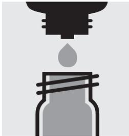
5 Tropfen O<sub>2</sub>-2K zugeben, mit Schraubkappe verschließen und 10 Sekunden mischen.
