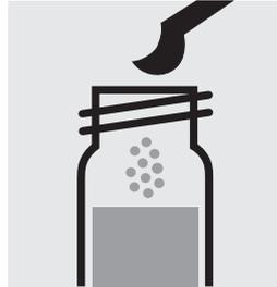
1 gestrichenen grünen Mikrolöffel **HCHO-1K** in eine Reaktionsküvette geben, mit Schraubkappe verschließen.
