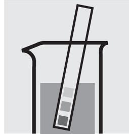
pH-Wert der Probe überprüfen, Soll-Bereich: pH 2–10. Falls erforderlich, tropfenweise mit verdünnter Natronlauge bzw. Salzsäure pH-Wert korrigieren.
